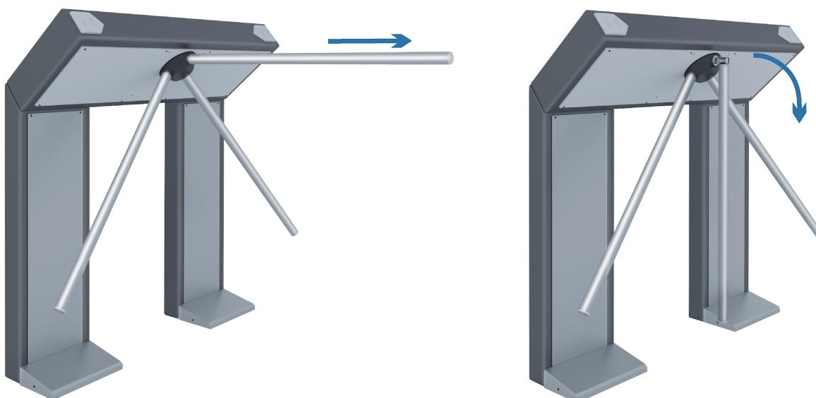
В чрезвычайной ситуации аварийным выходом могут служить преграждающие планки «Антипаника». Конструкция этих планок позволяет быстро организовать свободный проход без применения специальных ключей или инструментов. Для этого необходимо потянуть преграждающую планку, перекрывающую зону прохода, в осевом направлении в сторону от стойки турникета, до высвобождения механизма поворота планки, и затем сложить планку, опустив ее вниз.
