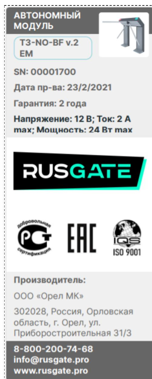
Маркировка турникета дублируется в электронном виде и остается неизменной при смене версии прошивки турникета. В состоянии поставки номер турникета указан в шифре Wi-Fi точки доступа турникета. Например ТОЕ0001700 (где 1700 порядковый номер турникета). Также информация доступна через приложение MasterCard путем нажатия кнопки NOM в меню ЗАПИСЬ СОБЫТИЙ (андроид устройство должно быть подключено к точке доступа Wi-Fi турникета).
